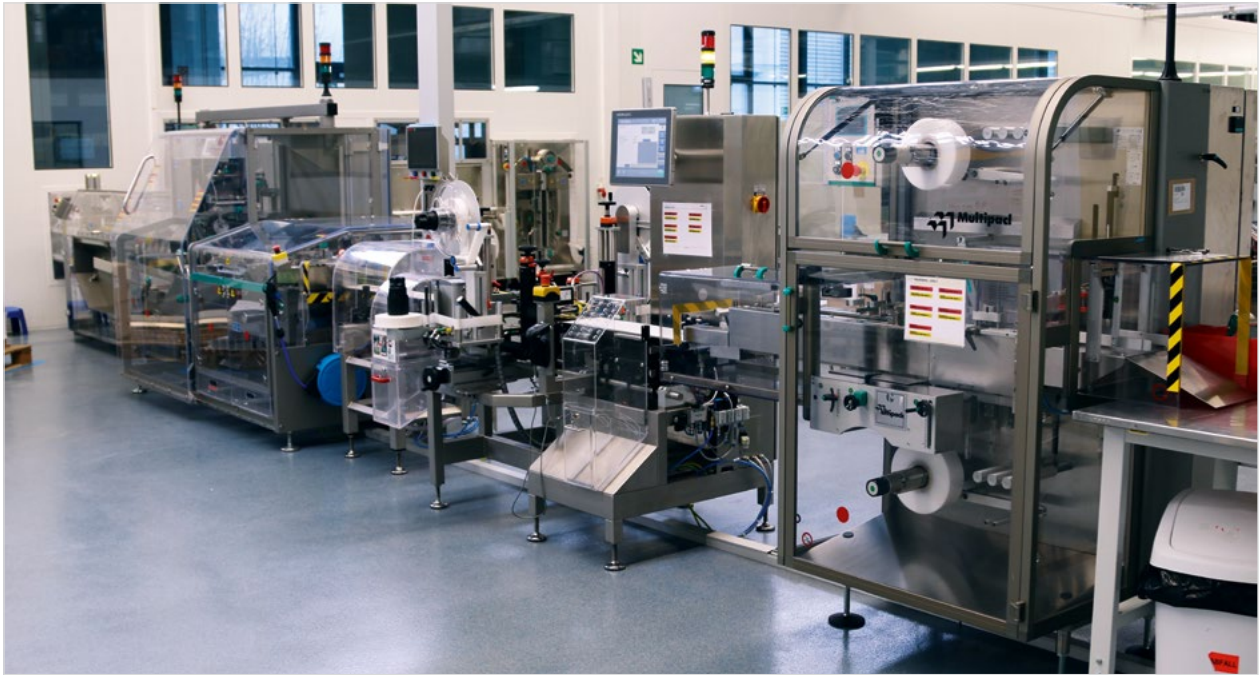
TQS-HC-A bei Acino in Aesch: Serialisierung, Gewichtsinspektion und Tamper Evidence-Funktionalität auf kleinster Stellfläche.
